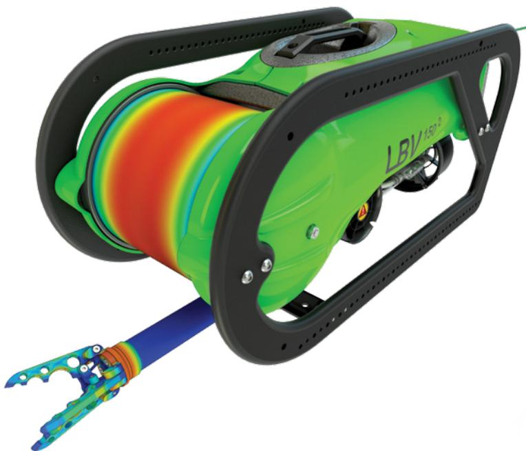
SOLIDWORKS Premium 付属の SOLIDWORKS Simulation は使用環境下での部品の応力、ひずみ、変形、変位を調べることで、稼働状態における故障を回避するのに役立ちます。
